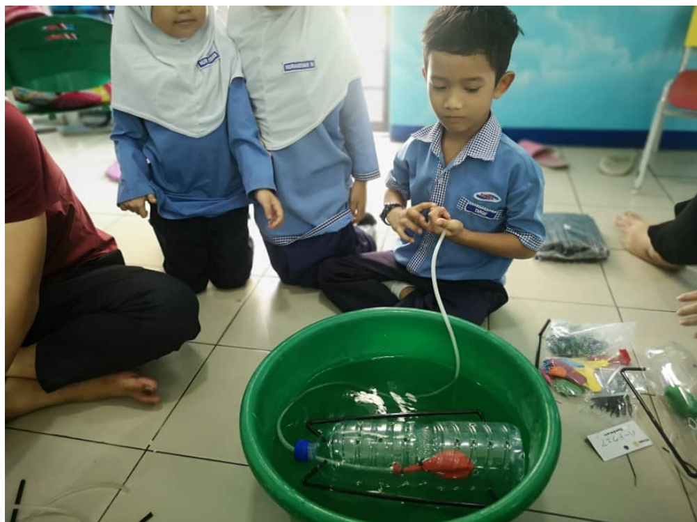
MENGUJI BOTOL AKAN TENGGELOM DALAM AIR. SEKIRANYA TIUB PLASTIK DI TIUP, BOTOL AKAN NAIK DAN TERAPUNG
